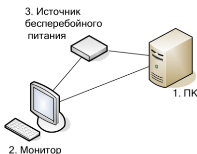
Рисунок 2. Структурная схема технических средств АРМ
